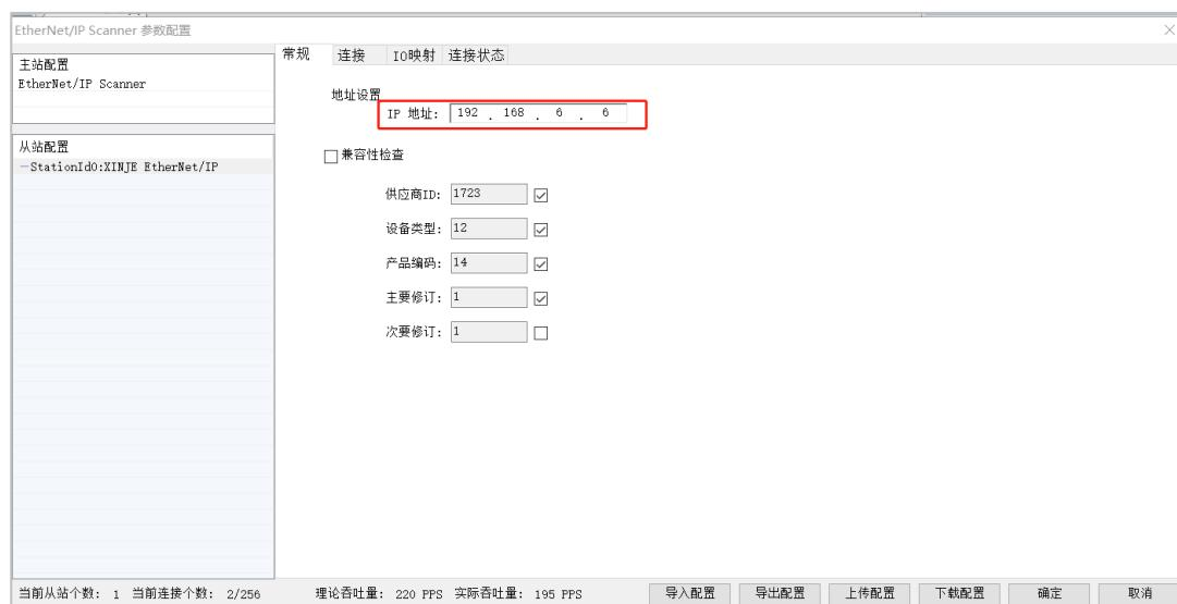
3、在 PLC2: XDH-60T-E (IP 为 192.168.6.7) 的扫描器 (Scanner) 上进行添加 InputOnly (ID) 连接类型的连接, 连接类型选择组播、连接点为 IN\_100、数据大小为 60 个字、映射首地址为 HD0、RPI (通讯周期) 为 100ms。
