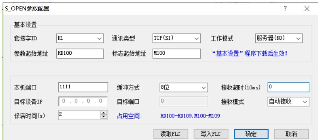
(2) 1号 PLC 上电后作为 TCP 服务器主动监听 1001 端口，等待 2号 PLC 的 TCP 客户端设备建立 TCP 连接并绑定套接字 ID 为 2，连接建立成功后向连接设备 2号 PLC 发送 D3000-D3549 的低八位数据，同时一直接收来自连接设备 2号 PLC 的数据，将数据存放到寄存器 D3600-D3999
