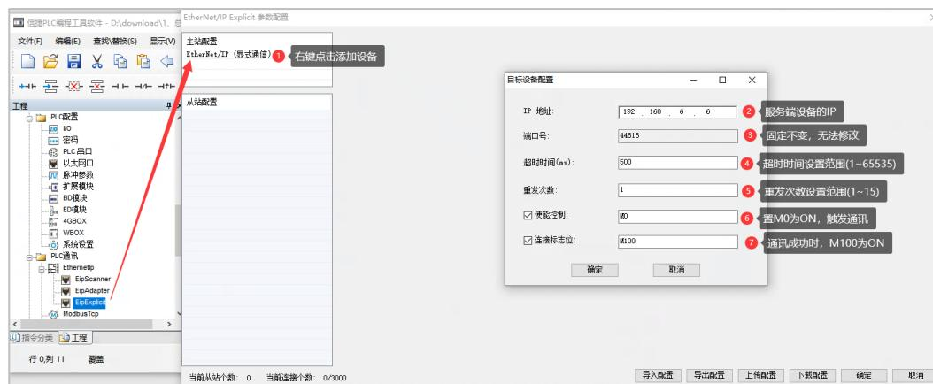
3、在客户端中添加连接，用户可以根据实际的应用场合选择对应的触发方式以及触发条件，进行对服务端的标签读写操作到客户端指定的映射地址中：
