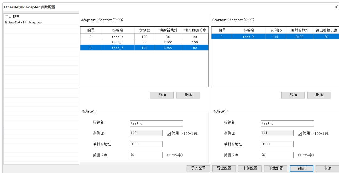
**2、**在基恩士 KV STUDIO 编程软件中，与待通讯的 PLC 连接完毕后，双击单元配置下的 KV-5500 进入单元编辑器-编辑模式，双击 CUP 单元对其 IP 地址进行配置，保证与适配器（Adapter）在同一网段中。
