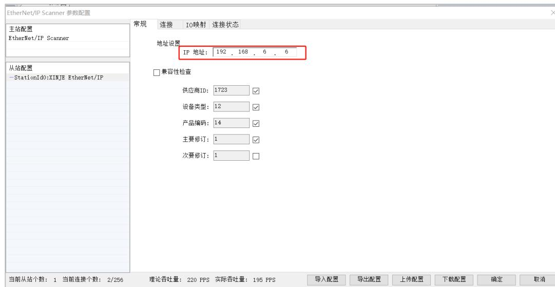
6、在 PLC3: XDH-60T-E (IP 为 192.168.6.20) 的扫描器 (Scanner) 上进行添加 ListenOnly(ID Type) 连接类型的连接, 进行监听 PLC1 发送给 PLC2 的 T->O 方向上的数据, 连接类型选择组播、连接点为 IN\_100、数据大小为 60 个字、映射首地址为 HD0、RPI (通讯周期) 为 100ms。
