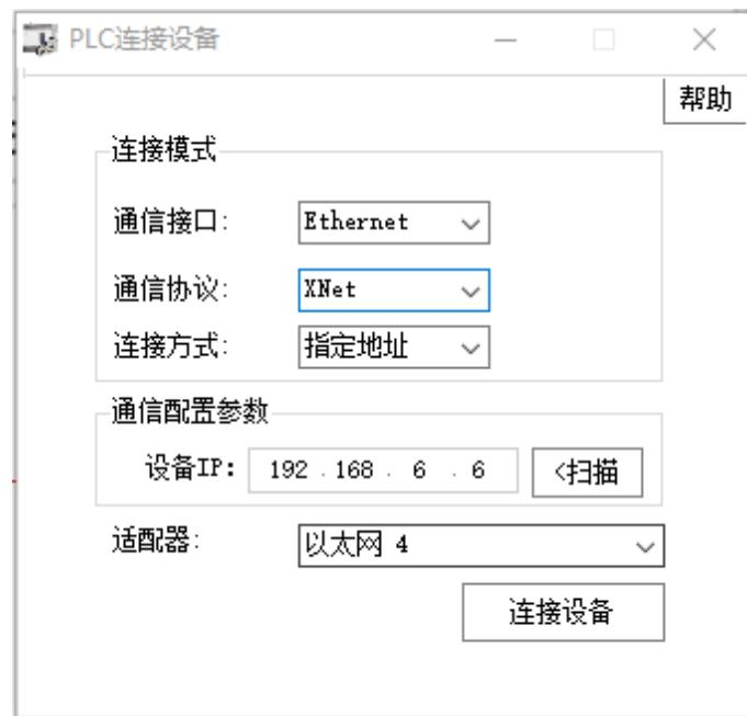
在进行对以太网参数进行配置时，选择以太网配置，配置项说明详见 2-1-1 节，功能与 XDPPro 的配置相同。
