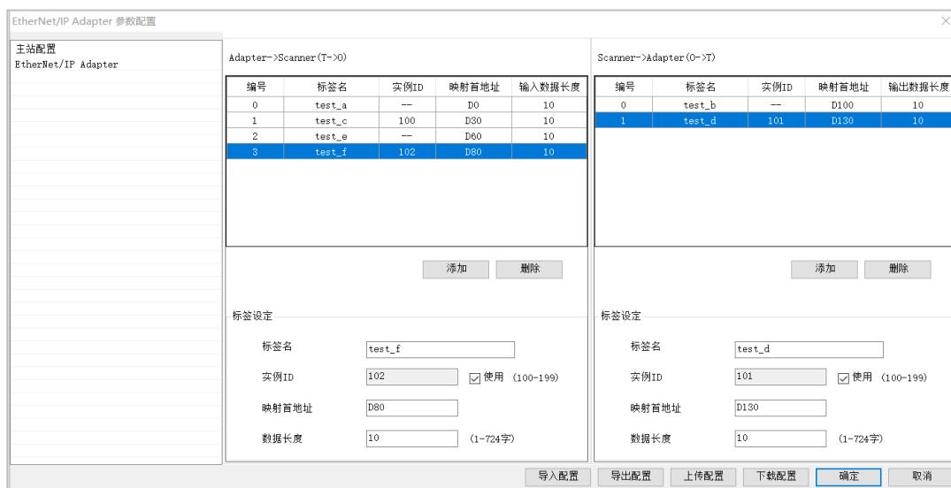
2、在欧姆龙 Sysmac Studio 编程软件中定义好需要进行 EIP 通讯的变量，在 EIP 通讯过程中需要与通讯对象进行数据接收处理的全局变量在网络公开选择输入，与通讯对象进行数据发送处理的全局变量在网络公开选择输出。
