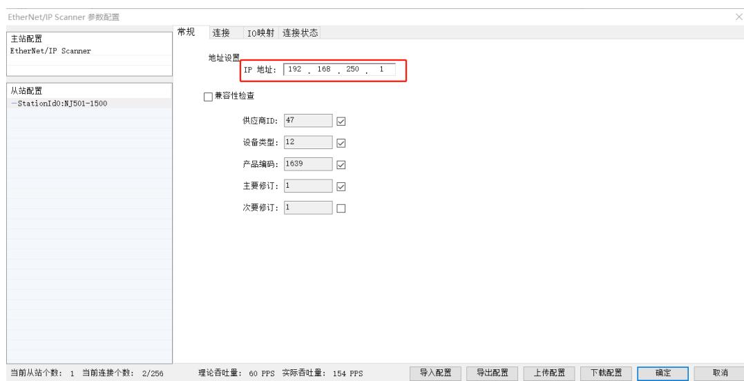
6、点击连接进行添加 Input Only(ID Type)、Input Only(tag Type)两种类型的连接，分别进行标签变量 (test\_bb)，输入数据长度为 10，输入映射首地址为 HD0，与实例 ID (IN\_100)，输入数据长度为 10，输入映射首地址为 HD10 的类型进行通信，配置完毕后点击下载配置，将配置下载到 PLC 中，配置的变量类型如下图所示：
