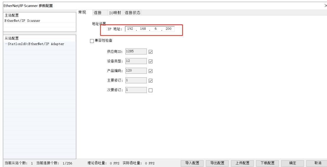
7、点击连接进行查看连接类型，对导入的连接类型也可以根据实际需要进行对应的修改。
