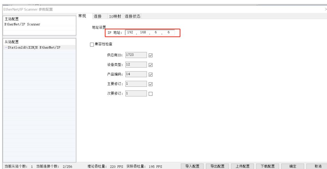
3、在扫描器（Scanner）上进行添加 ExclusiveOwner(Tag Type)、ExclusiveOwner(ID Type)两种类型的连接；建立 ExclusiveOwner(ID Type)第一连接，将 Adapter->Scanner 以输入连接点为 IN\_100，连接类型为点对点的数据接收到以 D20 为起始地址的 10 个寄存器中，将 Scanner->Adapter 以输出连接点为 OUT\_101，连接类型为点对点的 D30 为起始地址的 10 个数据发送出去；建立 ExclusiveOwner(Tag Type)第二条连接，将 Adapter->Scanner 以输入连接点为 test\_3，连接类型为点对点的数据接收到以 D40 为起始地址的 10 个寄存器中，将 Scanner->Adapter 以输出连接点为 test\_4 的，连接类型为点对点 D50 为起始地址的 10 个数据发送出去。
