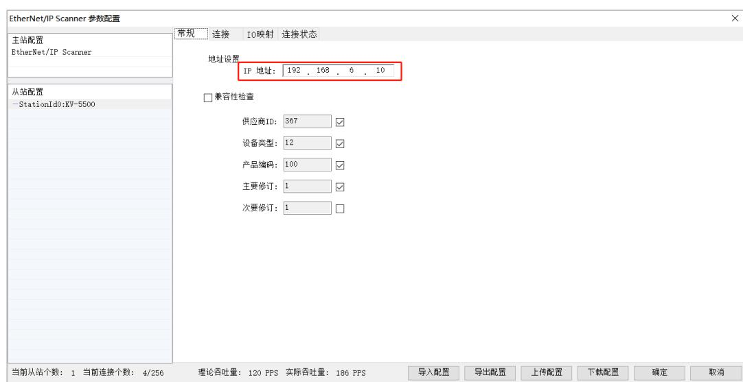
5、点击连接进行添加 Input Only(ID Type)、Input Only(tag Type)两种类型的连接，分别进行标签变量 (test\_1)，输入数据长度为 10，输入映射首地址为 D0；实例 ID (IN\_100)，输入数据长度为 10，输入映射首地址为 D20；标签变量 (test\_3)，输入数据长度为 10，输入映射首地址为 D40；实例 ID (IN\_101)，输入数据长度为 10，输入映射首地址为 D60 的类型进行通信，配置完毕后点击下载配置，将配置下载到 PLC 中，配置的变量类型如下图所示：
