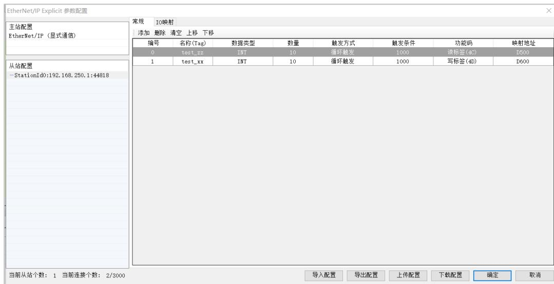
4、置位使能开关 M0 后，当 M100 使能连接标志位置位成功后表示连接建立成功，点击 IO 映射进行操作与查看读写数据是否通讯正常。
