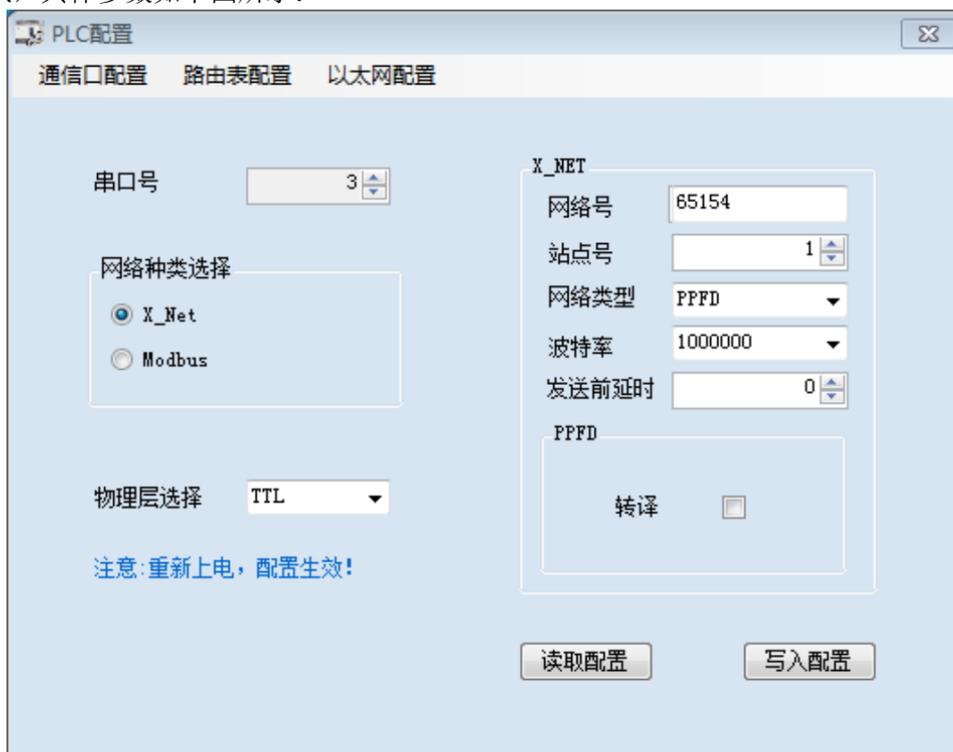
配置完成后点击“写入配置”, 弹出“写入成功”提示即表示配置完成, 重新上电后生效。重新上电后, XD-COBOX-ED 的 COM 灯闪烁, 表示 XD-COBOX-ED 与 PLC 的通讯正常。
