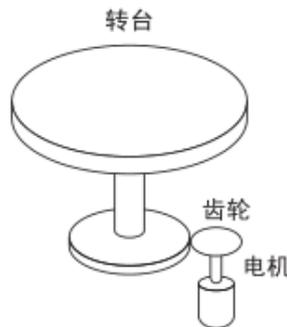
由于只能朝一个方向旋转，因此经过一定时间后，其旋转圈数总会超过绝对值编码器所能计数的上限值。
