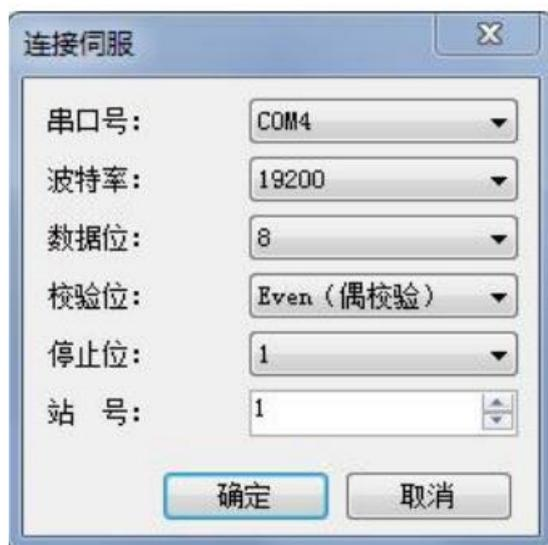
**注：**若串口配置正确，区域 1 和区域 2 显示信息，若配置错误或者串口被占用【与驱动器通信】窗口将显示【当前串口不可用，请重新检查并配置串口】。
