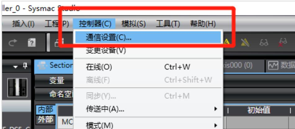
“通信设置”界面选择“Ethernet——直接连接”，然后点击“确定”关闭界面。
