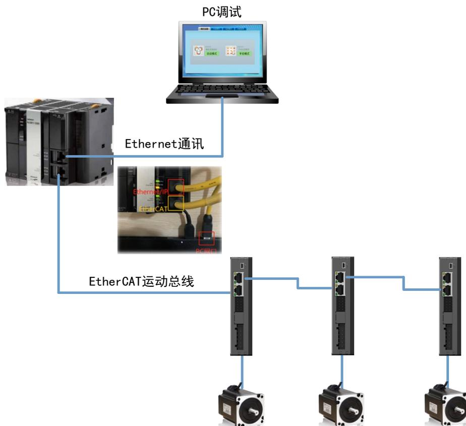
NJ501 CPU 模块带有两个网口，红色标注为 Ethernet/IP，用于连接 OMRON 上位机 Sysmac Studio 对 PLC 进行监控写入操作；黄色标注为 EtherCAT，另一端连接 XINJE DP3CL1 系列步进实现 EtherCAT 通讯。
