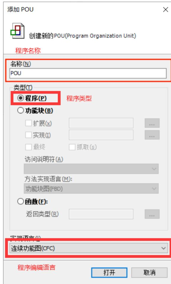
双击添加的 POU，就可在 POU 界面进行编程。注意：POU 要添加到任务里，因为后续的编译命令，只编译添加到任务中的程序。如果创建的 POU 没有添加到任务中，编译命令不对该 POU 进行语法检查。右击 EtherCAT\_Task，选择“添加对象”，在“程序调用”对话框中填入“POU”，最后点击“打开”进行添加。
