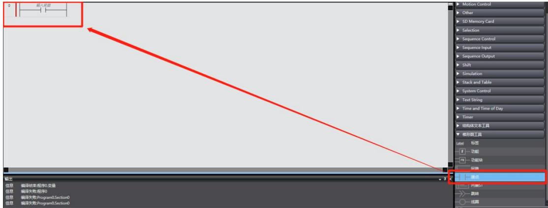
单击“输入变量”可写入变量名称。若为新变量名，会生成一个新变量，若为已有变量，可直接选择变量填入。新变量可在变量表中查看，右击变量 X0，选择“跳转到变量表”展开变量表。变量表中可以新建各种数据类型的变量供调用，也可查看已经定义的所有变量；
