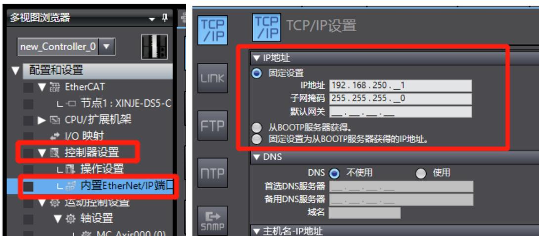
通信配置路径：“控制器——通信设置”；
