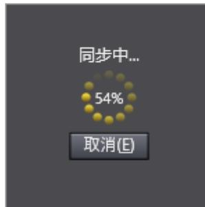
同步完成后单击“再比较”可查看本地工程 and 控制器工程各条目同步性，后续修改工程再次同步时，会详细标注与控制器工程不同的条目。
