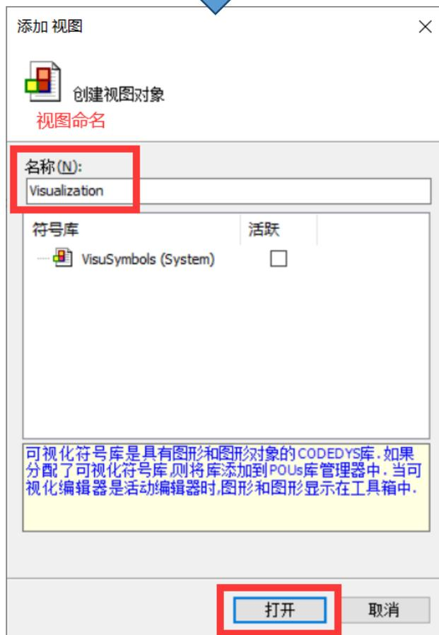
双击 Devices 一栏中的 Visualization, 就可在视图界面添加所需的视图。例如可在工具栏中搜索 power, 将使能功能的视图控件拖入视图画面中。
