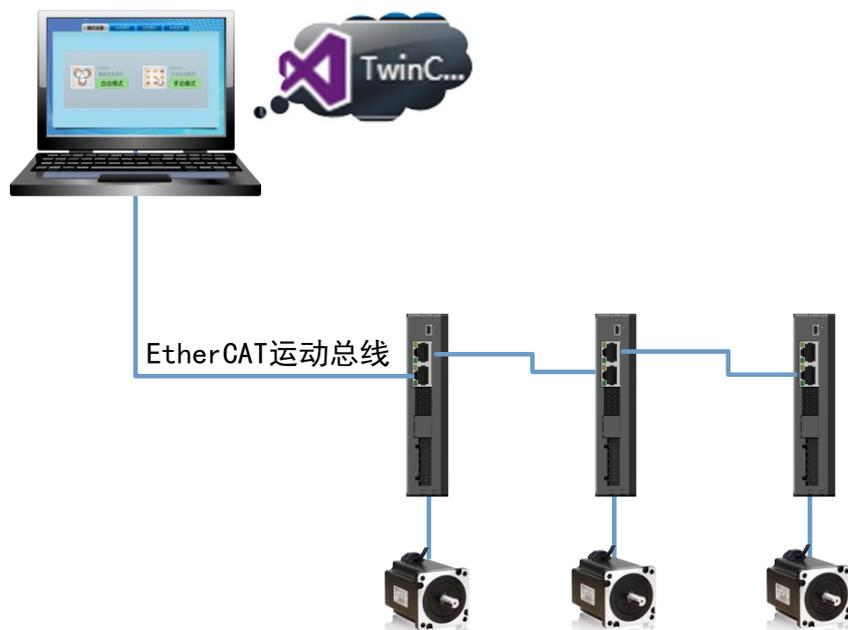
信捷DP3CL1系列步进驱动器的两个通讯网口遵循“下进上出”的原则，即主站必须与第一台步进 CN1 口下面的网口相连，再由第一台步进上面的网口与第二台步进下面的网口相连，依此类推。
