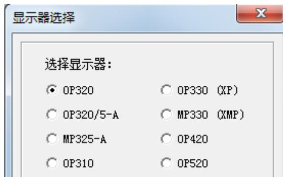
选择所使用的显示器的机型，OP320/-S 选择 OP320，OP330/-S 和 XP 系列一体机选择 OP330 (XP)，OP320-A/-A-S/-A-N 和 OP325-A/-A-S 选择 OP320/5-A，MP330/-S 和 XMP3-18（已停产）选择 MP330（XMP），MP325-A/-A-S 选择 MP325-A，OP420（已停产）选择 OP420，OP310（已停产）选择 OP310，OP520（已停产）选择 OP520，点击“确定”按钮，屏幕中弹出 PLC 机型选择对话框：
