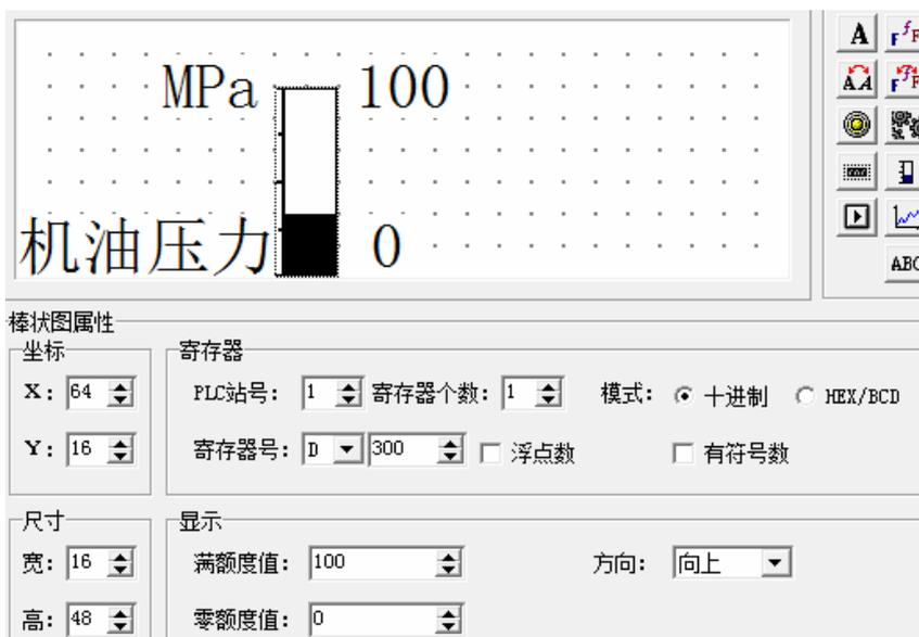
该棒状图监视 D300 中的数据，当棒状图满刻度显示时，表示 D100 中的数据为 100；当棒状图显示为 50% 刻度显示时，表示 D300 中的数据为 50。
