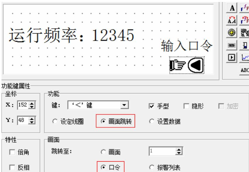
4、程序编辑完毕，画面下载结束后，在显示器上，点击“SET”键，数据输入部件没有任何反应，需要按下“
