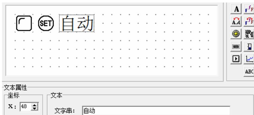
以同样方法设置手动按钮，手动状态指示灯。指示灯的地址仍然对应 M10，显示属性取“负逻辑”。指定按钮为“ENT”键，按钮功能选择为“设定为 OFF”。
