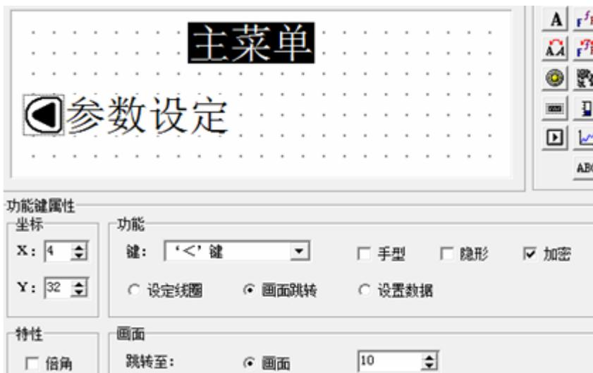
以同样方法在画面右侧放置功能键“>”键及文本“状态设定”，表示按“>”键进入状态设定画面。可以将 20 号画面确定为状态设定画面。
