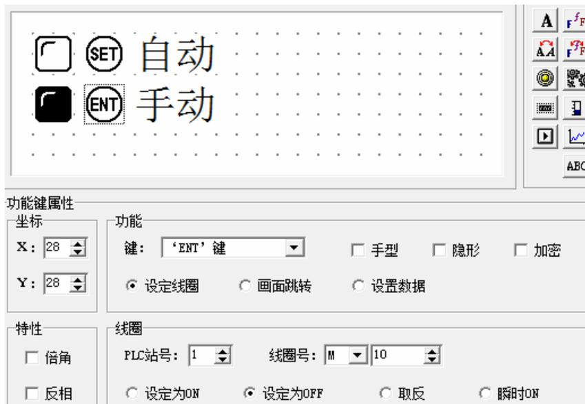
设置 2 个圆形指示灯，正逻辑，地址分别对 M20 和 M21，监视电机的运行状态。当左边指示灯亮时，表示电机正向运转；当右边指示灯亮时，表示电机反向运转。
