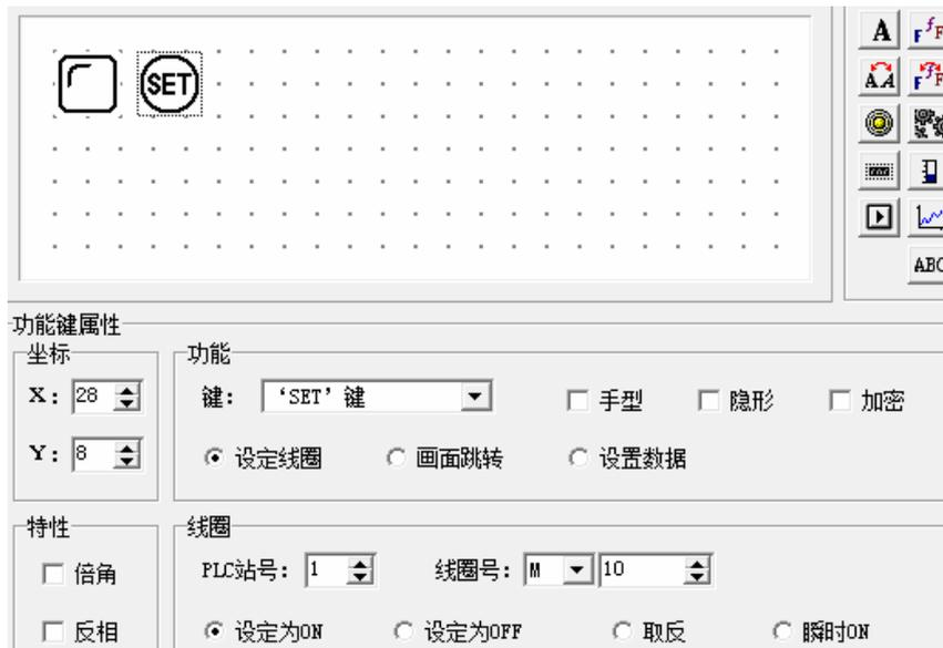
选择设定线圈功能，线圈属性包括继电器定义号、按键动作类型。
