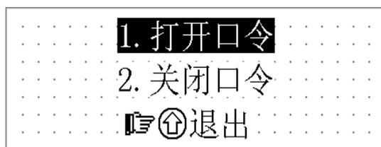
(1) 选择 1, 执行“打开口令”操作, 点击“ENT”进入输入口令画面, 按“^”键或“v”键输入密码值, 按“<”键或“>”键进行移位, 密码输好后按“ENT”键确认。
