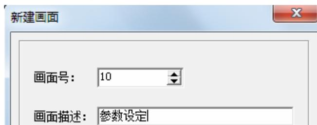
点击“确定”键确认。在界面右下角画面属性中，将“∧”键跳转画面号置为“1”，“∨”键跳转画面号置为“20”。该设置在正常显示状态下（不在数据设定状态），按“∧”键直接进入主菜单画面，按
