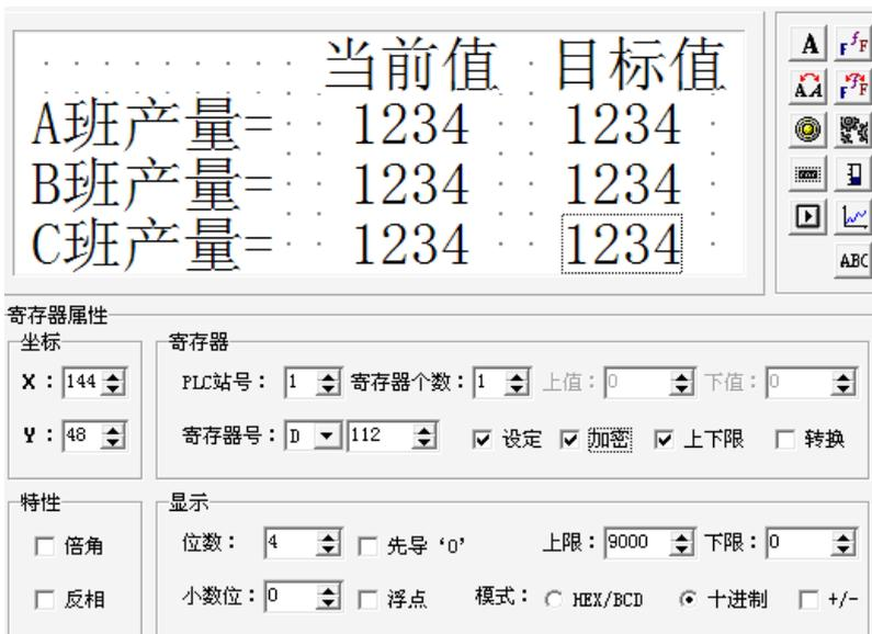
**注意：**三个数据设定被编辑的顺序（即鼠标点击顺序）和实际操作时被设定的顺序相同。如果在保存工程之前用鼠标从上到下依次点击三个数据设定部件，运行时，首先设定 A 班产量，其次设定 B 班产量，最后设定 C 班产量。
