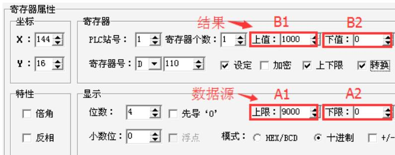
$$\text{计算公式: 比例转换后结果} = \frac{B1-B2}{A1-A2} \times (\text{数据源数据} - A2) + B2$$
