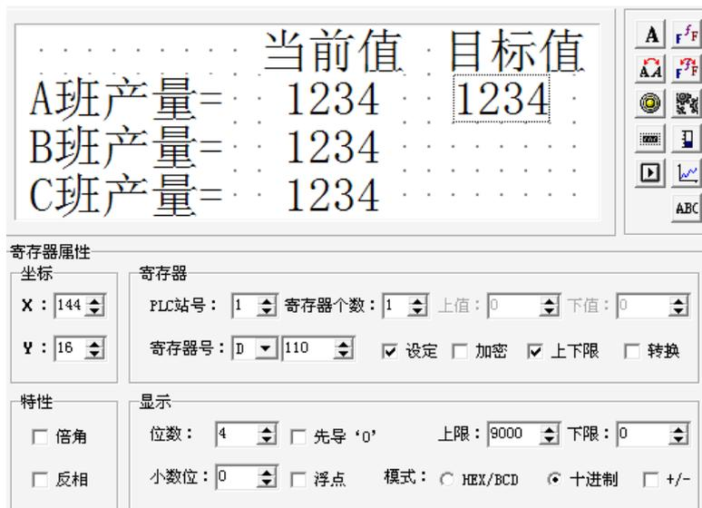
依次设置其它属性：寄存器号=D110，寄存器个数=1，数据位数=4，小数点位数=0，以十进制形式显示。以同样方式设置 B 班和 C 班产量设定。B 班设定值对应 D111，C 班设定值对应 D112。
