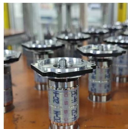
轴承&端盖压装
