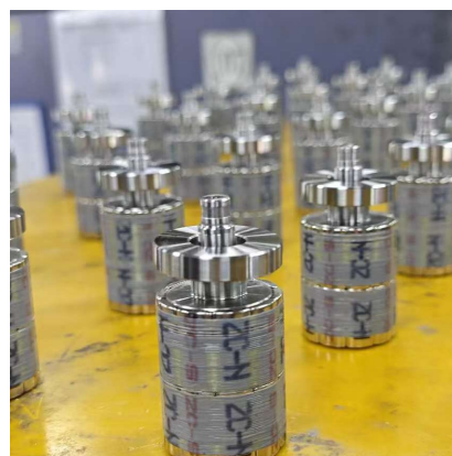
惯量配重盘压装
