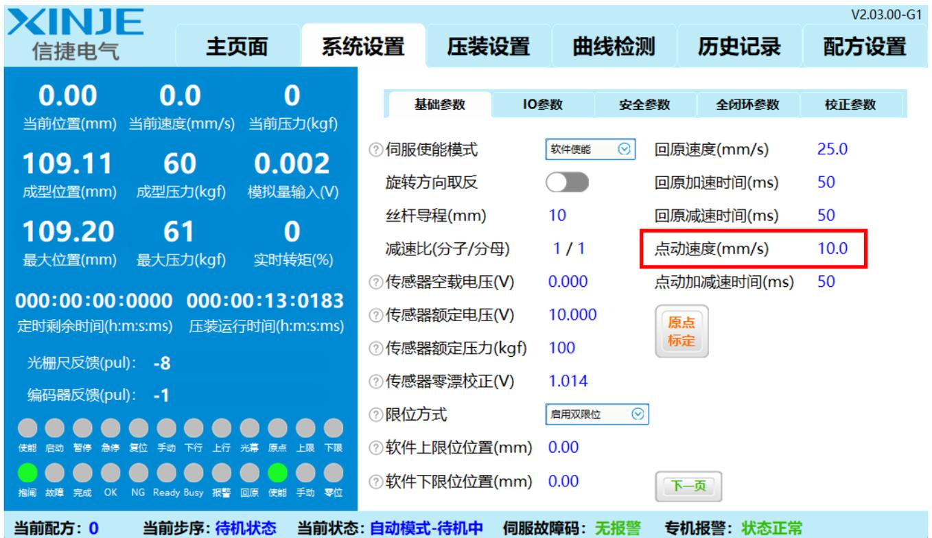
该截图展示了 XINJE 系统的“系统设置”界面。顶部有 XINJE 品牌标识和“快捷电气”字样，以及版本信息 V2.03.00-G1。主菜单包含“主页面”、“系统设置”、“压装设置”、“曲线检测”、“历史记录”和“配方设置”。当前显示的是“基础参数”子页面，其中“点动速度(mm/s)”参数被红色方框高亮显示，其值为 10.0。界面左侧显示了当前的位置、速度、压力、成型位置、压力、模拟量输入、最大位置、最大压力、实时转矩、定时剩余时间和压装运行时间。底部状态栏显示当前配方为 0，当前步序为待机状态，当前状态为自动模式-待机中，伺服故障码为无报警，专机报警为状态正常。
