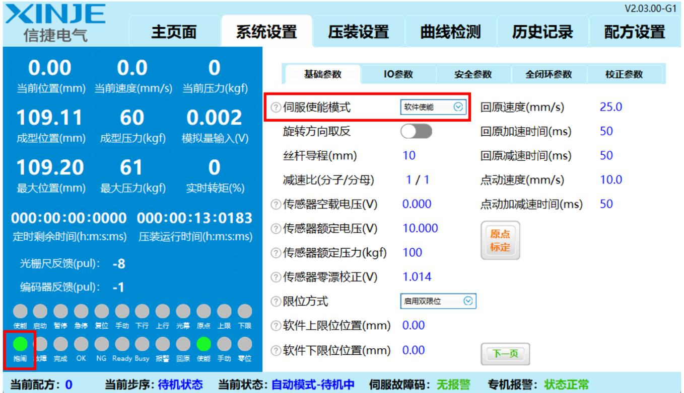
该截图展示了 XINJE 信捷电气 V2.03.00-G1 的系统设置界面。顶部有“主页面”、“系统设置”、“压装设置”、“曲线检测”、“历史记录”和“配方设置”等选项卡。在“系统设置”下，选择了“基础参数”子页面。左侧显示了实时运行数据，包括当前位置、速度、压力、成型位置、压力、模拟量输入、最大位置、压力、实时转矩、定时剩余时间和压装运行时间。右侧是参数配置列表，其中“伺服使能模式”被设置为“软件使能”，并用红色框标出。底部状态栏显示当前配方为 0，当前步序为待机状态，当前状态为自动模式-待机中，伺服故障码为无报警，专机报警为状态正常。
