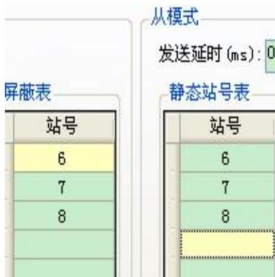
静态站号表: 站号 6, 站号 7, 站号 8, 其目的在于将 T-BOX 内中记有所连接的 Modbus 从设备的站号。
