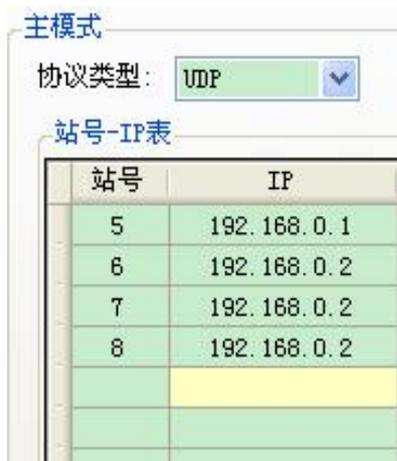
站号-IP 表: 站号 5, 站号 6, 站号 7, 站号 8, 表示 T-BOX 发送数据时以对应方式向目标站号直接发送。IP 地址对应的是每个 PLC 上所连接 TBOX 的 IP 地址。
