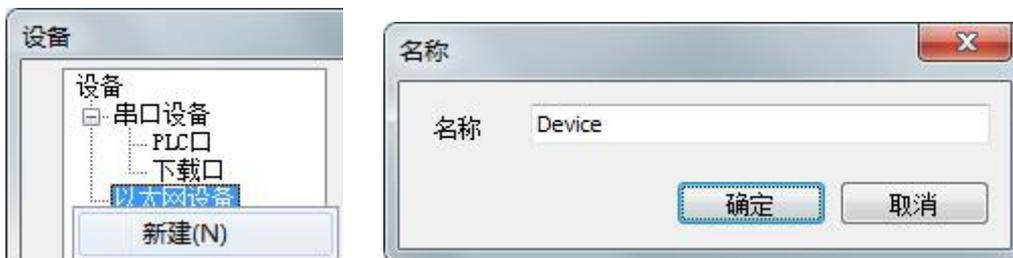
3、和 T-BOX 通讯，选择 Modbus Tcp 设备，此 IP 地址为 T-BOX 的 IP 地址（可通过 PLC 软件设定）；端口号默认为 502，不可修改；
