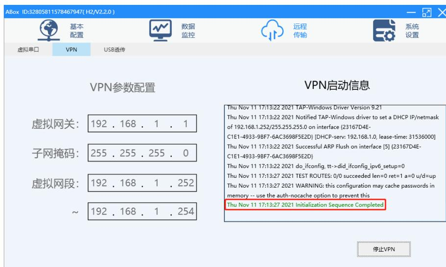
5、VPN 透传及透传过程中，打开 PLC 软件，直接连接 PLC 的 IP 地址，即可对 PLC 进行远程下载；
