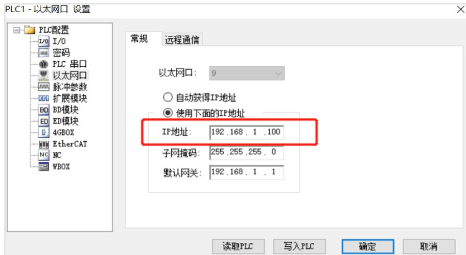
2、将 A-BOX 局域网口 IP 设置为和 PLC 在同一个网段。
