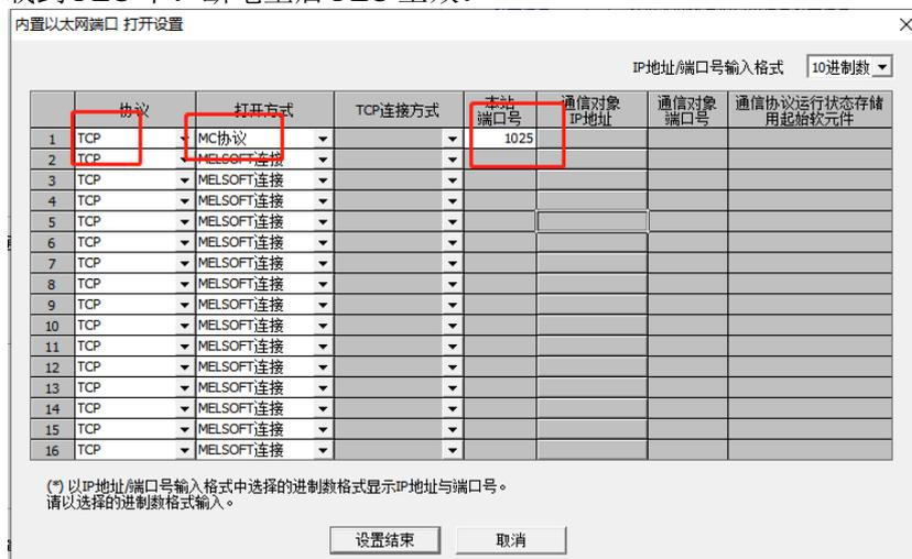
4、使用 BOX Manager 连接 A-BOX，首先修改 A-BOX 的局域网网关。使 A-BOX 的局域网网关与 PLC 的 IP 地址在同一网段。本案例 PLC 的 IP 为 192.168.3.39，则 A-BOX 的局域网网关设置为 192.168.3.1。
