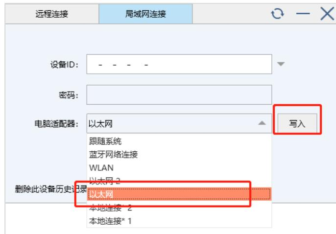
3、点击“查询可用设备 ID”，会自动查询局域网内的所有 ABOX。双击指定的设备 ID，进行连接。
