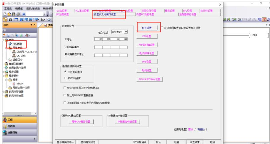
3、“协议”选择 TCP，“打开方式”选择 MC 协议，“本站端口号”填写 1025。端口号可任意设置。设置好后将参数下载到 PLC 中。断电重启 PLC 生效。
