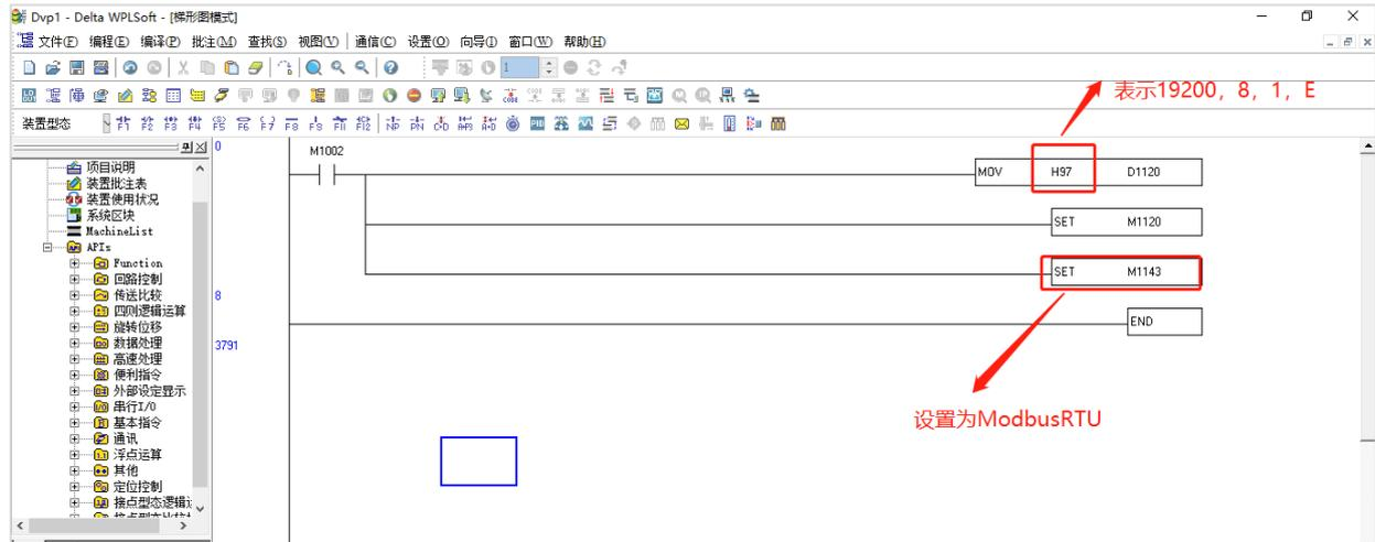
2、使用 RS485 将 PLC 与 A-BOX 连接。本案例连接 A-BOX 的 COM0。首先将 A-BOX 的串口参数设置与 PLC 一致。
