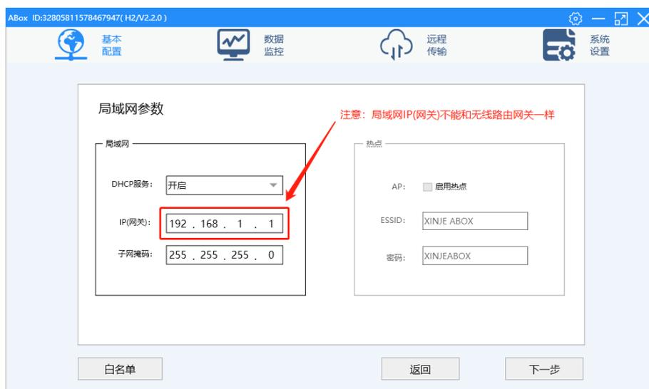
白名单启用可以在网关局域网内的设备具备上网功能，设备的 IP 信息需要设置好包括 IP 地址以及 DNS 地址（DNS 服务器 114.114.114.114、备用服务器 8.8.8.8）。
