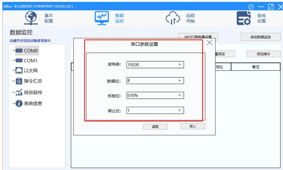
2、点击“数据监控”，右击相应的 COM 口，点击“协议设置”，选择“ModbusRtu”。
