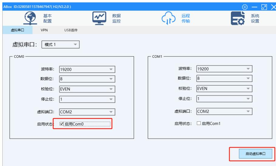
3、使用配置工具连接当前 A-BOX，在“用户功能”->“虚拟串口”，选择 A-BOX 所使用的 COM 口，选择“我的电脑”中空闲的 COM 口。并点击“启动虚拟串口”。
