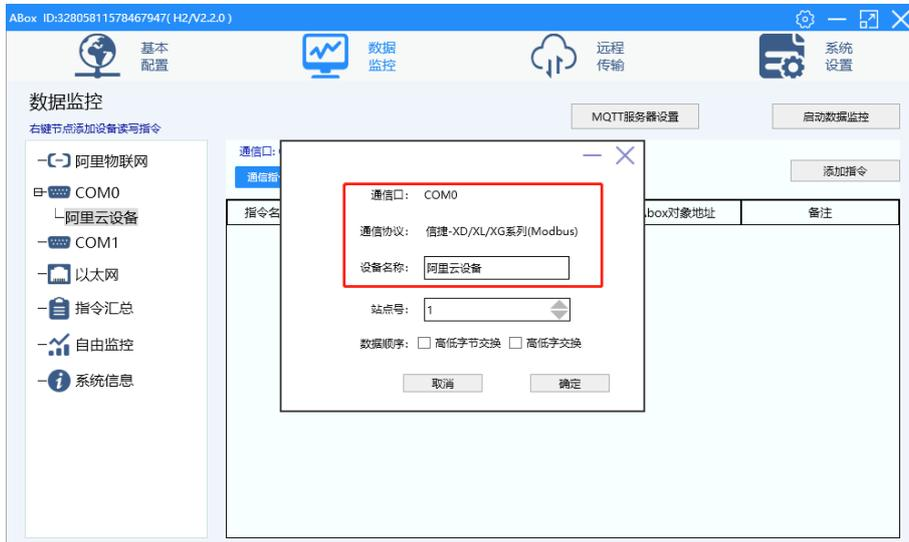
13、添加指令时，会自动显示物联网平台添加的物模型列表，配置 PLC 对应的地址，配置 MQTT 的触发形式。
