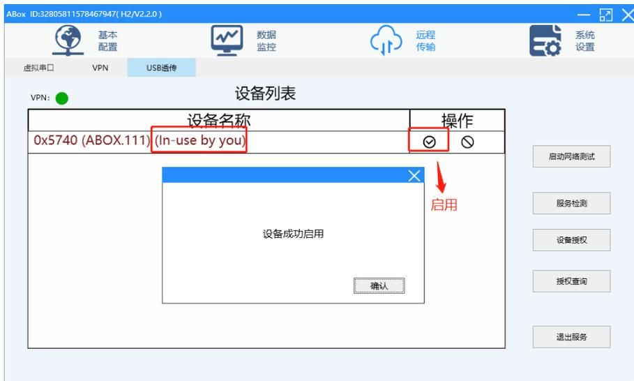
6、设备列表中，设备名后面显示“in-use by you”，表示正在使用该设备，直接打开触摸屏编辑软件，新建画面后点击下载即可；
