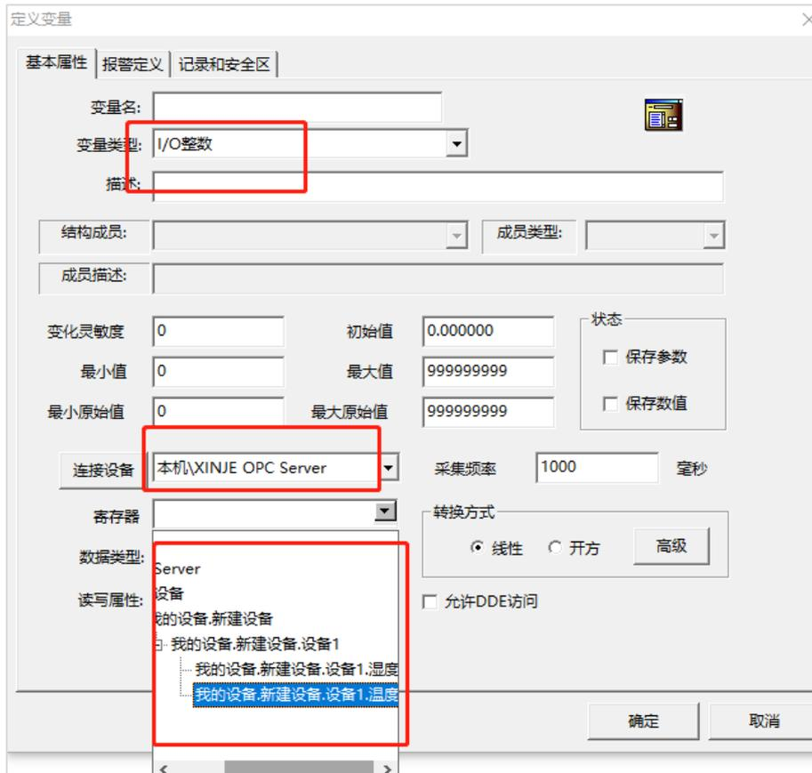
9、新建画面，绑定数据，根据数据点的属性设置相对应的输入输出属性。
