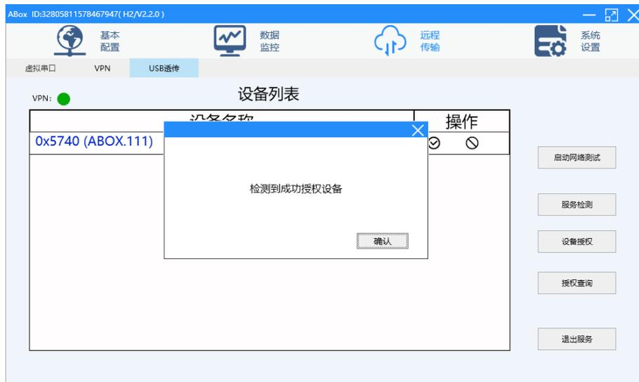
5、打印机线连接 USB 口和触摸屏，设备列表中自动弹出 USB 口检测到的设备，点击“√”启用当前 USB 设备。
