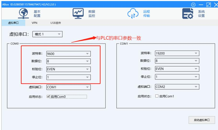
3、选择 COM0，虚拟到本地的 COM4 口。点击“启动虚拟串口”。
