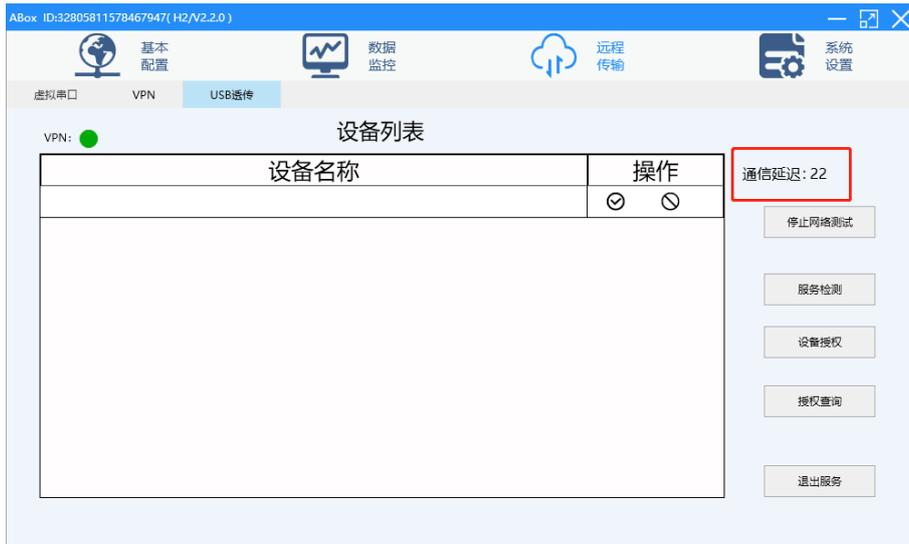
3、服务检测：检测透传工具驱动是否安装完成；
