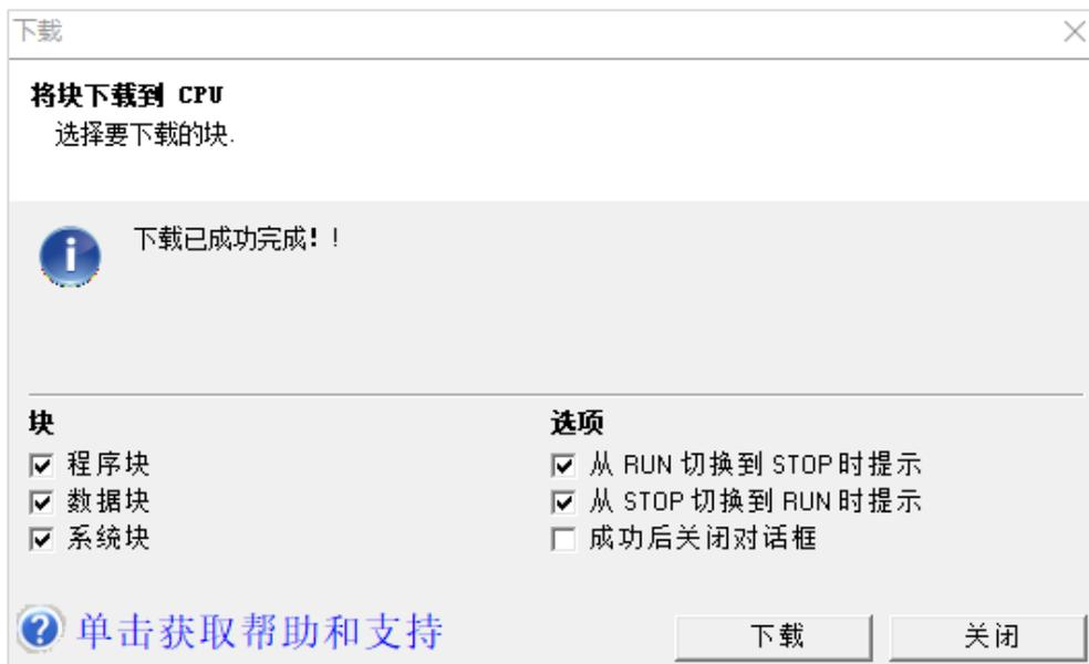
5、参数下载完成后，用网线将 PLC 与 A-BOX 的 LAN 口连接。待 A-BOX 登录到服务器后，使用配置工具连接到当前 A-BOX。在“用户功能”->“VPN”中，点击“写入、启动 VPN”。
