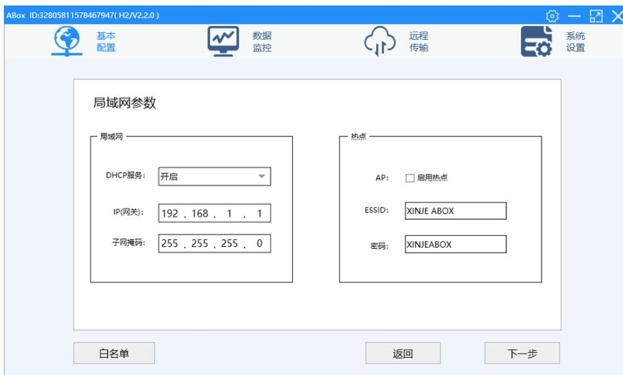
2、将需要 VPN 的 PLC 的以太网口 IP 地址固定，PLC 的 IP 地址需要与 A-BOX 在同一网关，以默认网关举例，PLC 的 IP 地址设置为 192.168.1.XX（XX 的范围是 2~251）。信捷网口系列 PLC 设置如下图所示：
