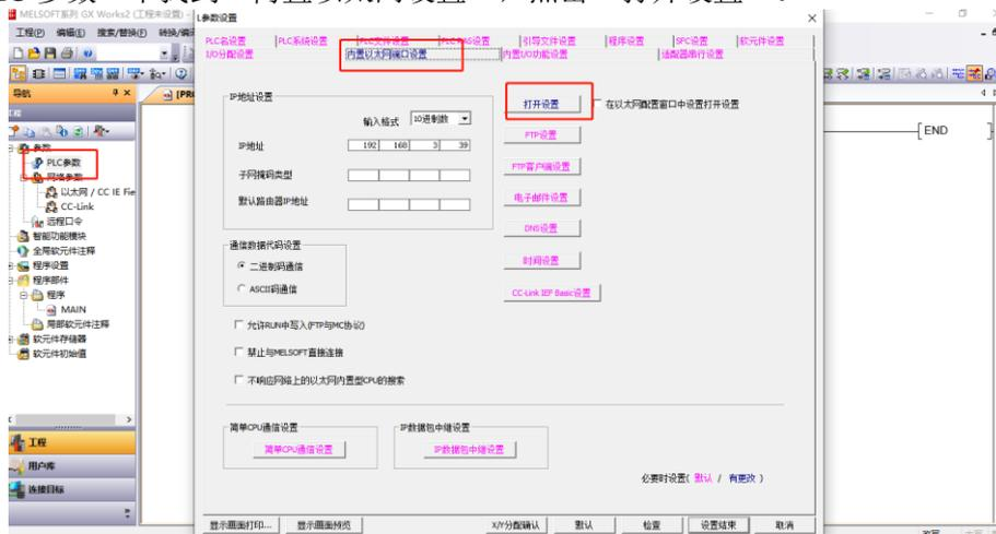
3、“协议”选择 TCP，“打开方式”选择 MC 协议，“本站端口号”填写 1025。端口号可任意设置。设置好后将参数下载到 PLC 中。断电重启 PLC 生效。
