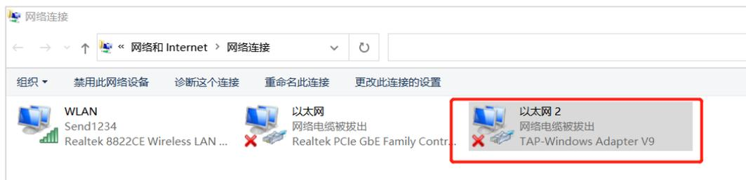
如果没有请重新安装“XNetConfigTool”。安装后再重新查看上述驱动。
