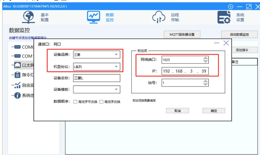
7、选择添加的设备，点击添加指令，配置 PLC 地址与 A-BOX 地址的映射关系。添加完成后点击“启动数据监控”。
