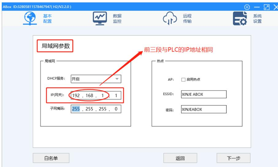
16、确认 PLC 或其他网口设备的 IP 地址和端口。一般 Modbus-TCP 的端口号为 502；信捷 XDE 系列 PLC 端口为 531，西门子网口通讯端口为 102。同一台 ABOX 网口支持多种协议同时使用。
