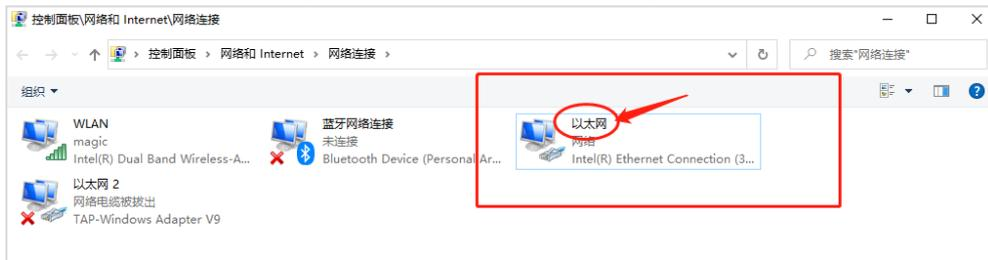
2、打开 BOX Manager 配置工具，首页点击“跳过”，进入“局域网连接”，将电脑适配器选择上图中的网卡名称，并点击“写入”。
