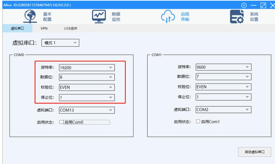
7、写入后，将 COM0 虚拟串口，例如虚拟到本地的 COM13。
