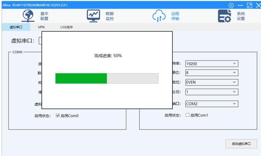
4、虚拟串口建立完成后，可打开编程软件，选择虚拟的 COM 口，进行连接，从而实现远程对 PLC 的在线下载程序、监控调试等功能；
