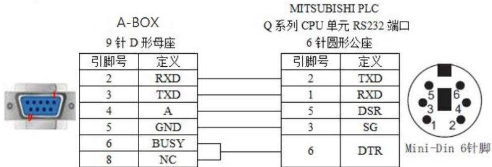
2、远程连接 A-BOX，设置 COM0 的串口参数为：9600，8，1，奇。（切记不能使用 115200 bps）
