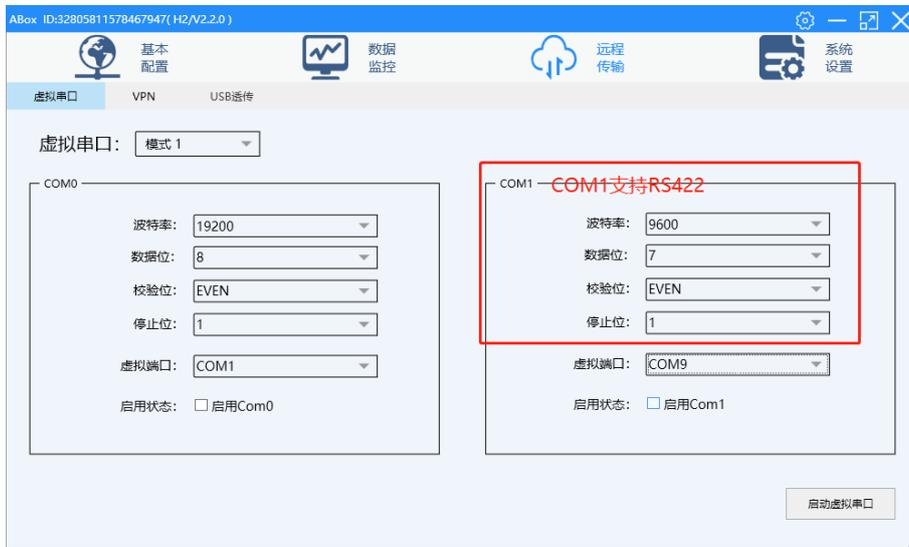
2、写入并生效后，点击虚拟串口，将 COM1 虚拟到本地端口，例如 COM9。
