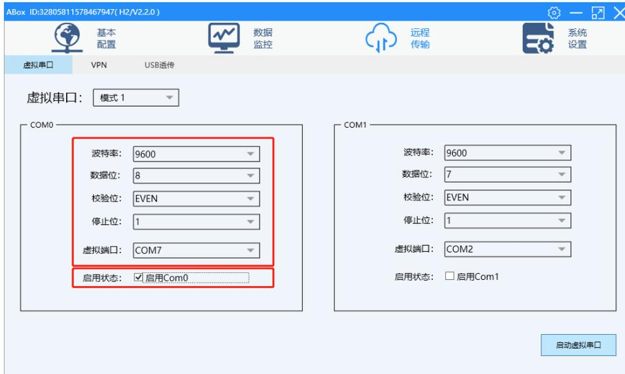
2、使用 DVP 线将 PLC 与 A-BOX 连接。启动虚拟串口。本案例虚拟到本地 COM7。可在设备管理器中查看驱动是否正常。
