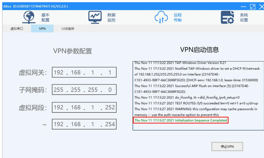
7、VPN 透传及透传过程中，也可以使用 ping 命令先测试连接是否正常，再打开西门子 PLC 软件，在“PLC”->“设定”中，点击添加 CPU，将 PLC 的 IP 地址 192.168.1.150 手动填入。
