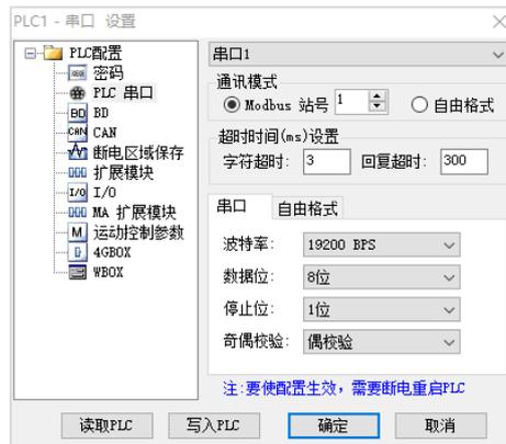
2、A-BOX 模块 COM0 和 COM1 的默认串口参数同样是 19200，8，1，E。因此只需将 XC 系列 PLC 与 A-BOX 通过 RS232 或 RS485 连接起来即可。
