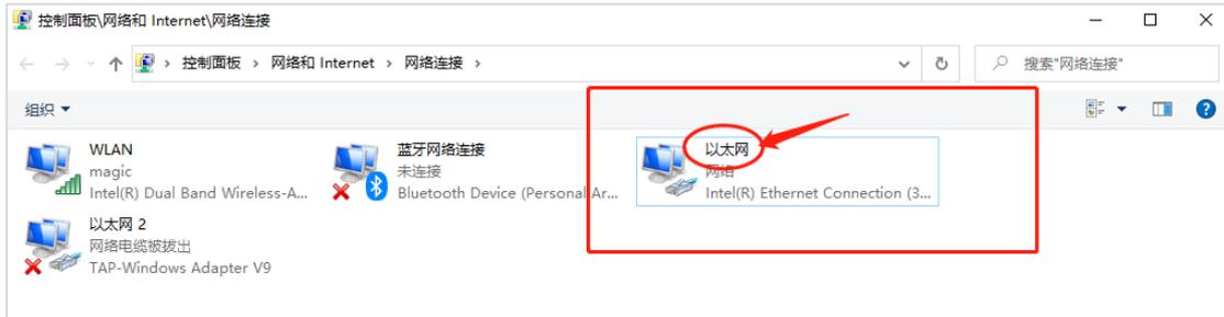
② 打开 BOX Manager 配置工具，首页点击“跳过”，进入“局域网连接”，将电脑适配器选择上图中的网卡名称，并点击“写入”。
