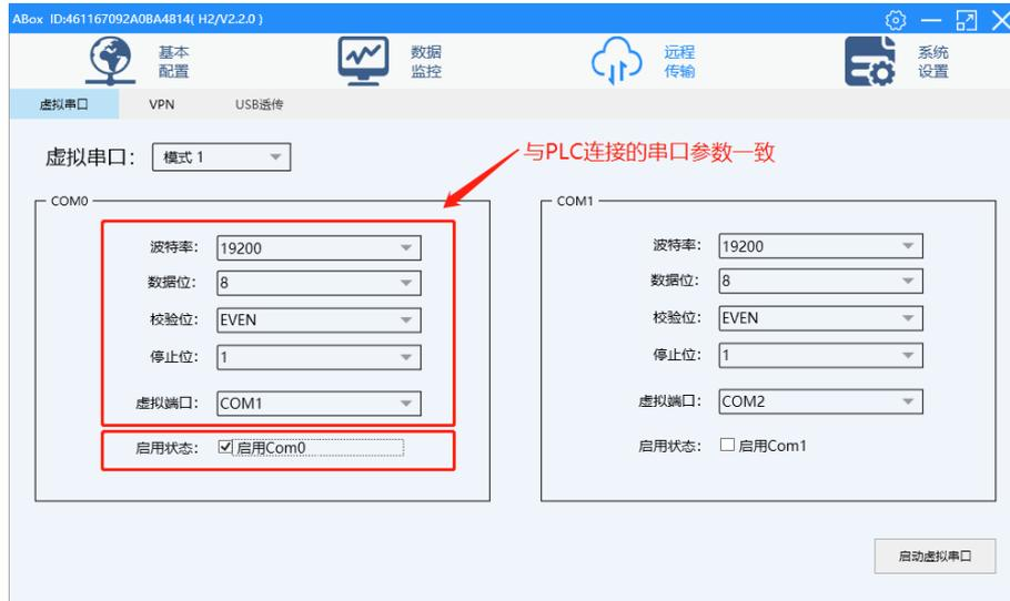
2、点击“虚拟串口”，选择 A-BOX 所使用的 COM 口，选择“我的电脑”中空闲的 COM 口，并点击“启动虚拟串口”；
