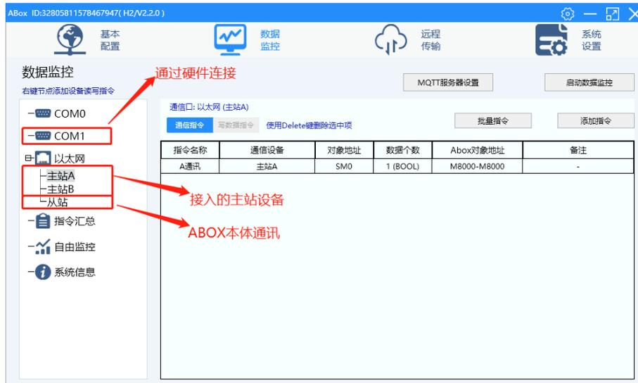
在从站中配置的通讯指令中, 对象地址和 ABox 对象地址处于同一储存片区地址, 所以不能将两个地址放在同一存储片区;
