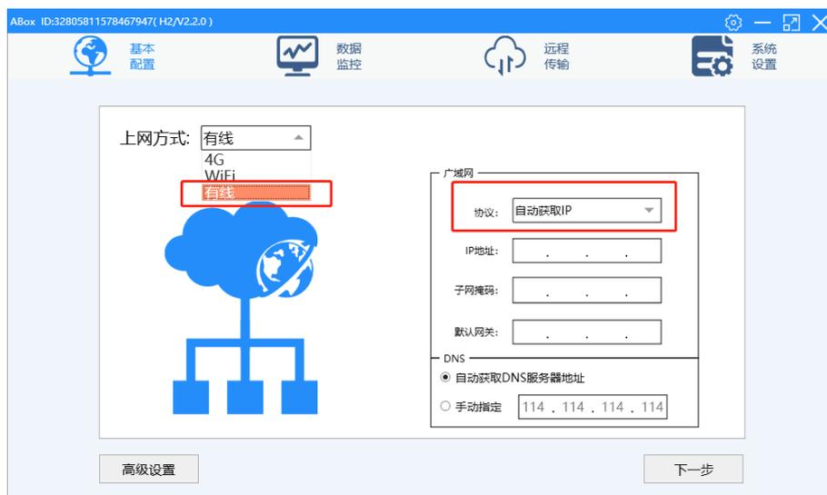
部分网络需要指定的 IP 和 DNS 服务器上网时，可选择“指定 IP 地址”，手动输入 DNS 服务器。
