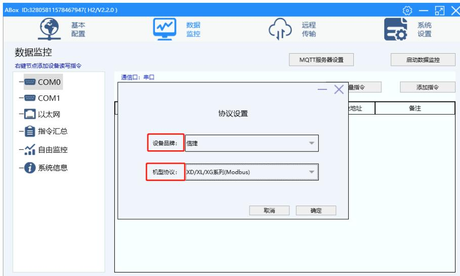
再右击 COM 口点击“添加设备”。定义设备名称和站点号。设备模板的作用是，一个 A-BOX 连接多个同机型同数据点的设备时，复制配置表。
