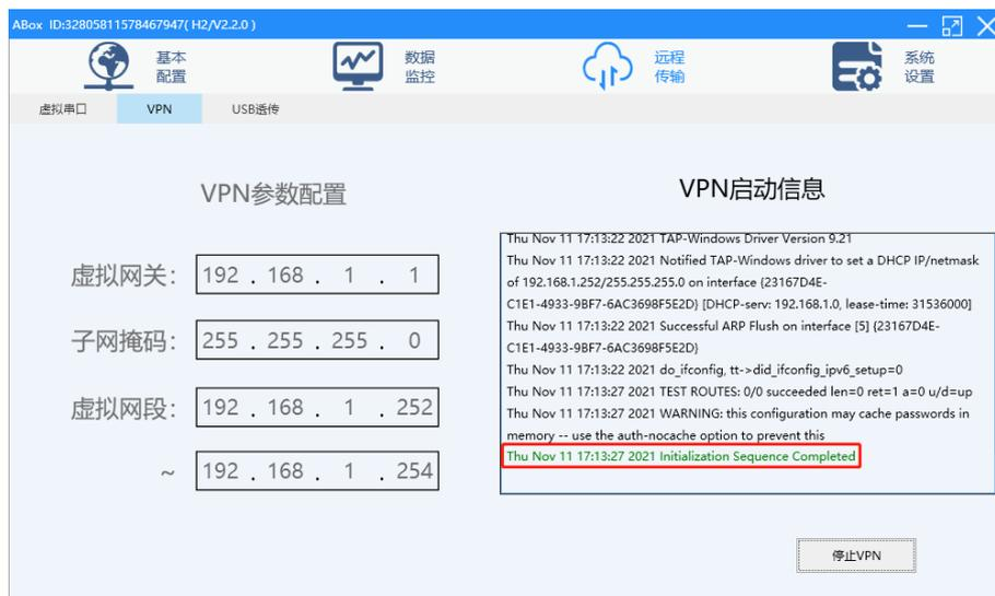
VPN 成功后，可通过“VPN 网络设备扫描”，对 VPN 网段下进行 IP 扫描。
