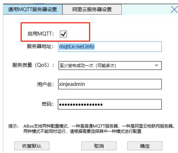
4、按连接的 PLC，选择相应的串口或网口新建设备，并添加“通信指令”，数据的“发布模式”，改为“高性能”模式。配置好需要监控的数据后，点击“启动数据监控”。
