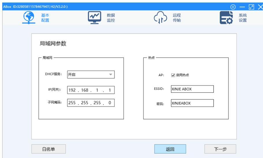
白名单启用可以在网关局域网内的设备具备上网功能（定向流量卡除外）设备的 IP 信息需要设置好包括 IP 地址以及 DNS 地址（DNS 服务器 114.114.114.114、备用服务器 8.8.8.8）；
