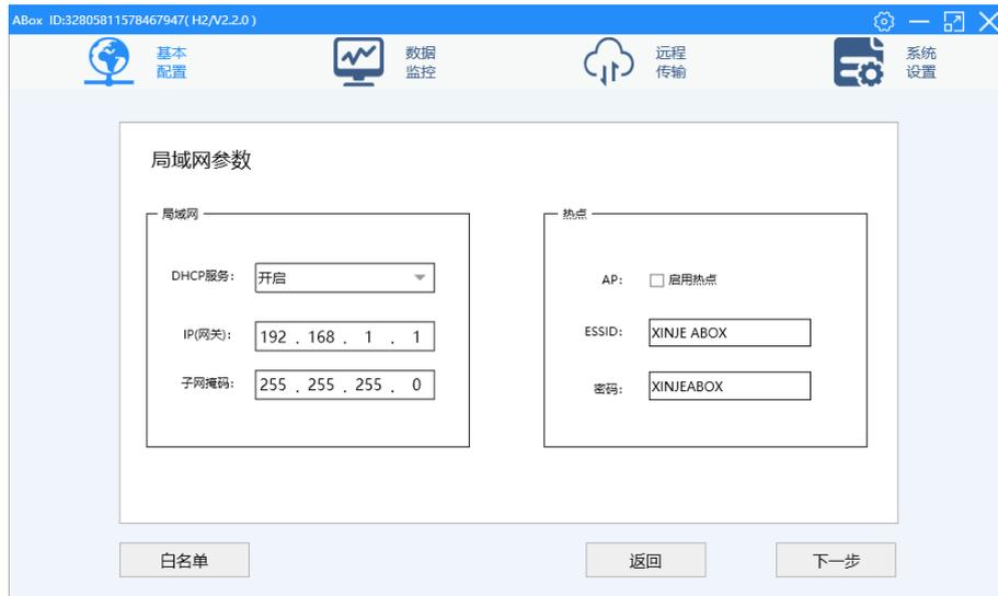
2、将需要 VPN 的 PLC 的以太网口 IP 地址固定，PLC 的 IP 地址需要与 A-BOX 在同一网关，以默认网关举例，PLC 的 IP 地址设置为 192.168.1.XX (XX 的范围是 2~251)。信捷 XDE 系列设置如下图所示：
