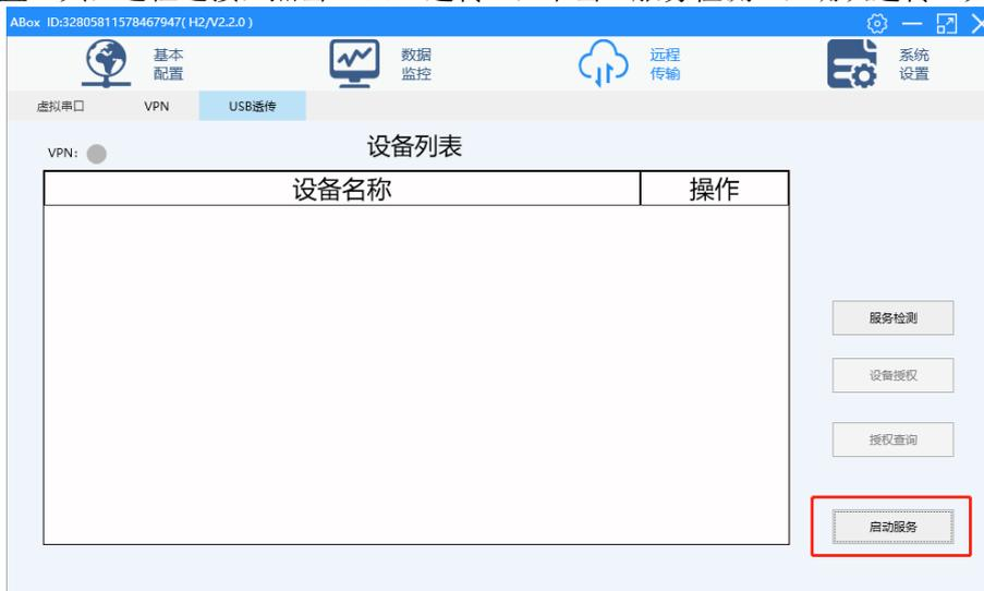
2、点击“启动服务”，启动 USB 透传，点击启动网络测试，可查看当前网络延时，信号良好时一般在 150ms 以内；
