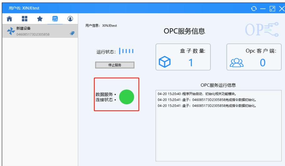
7、启动成功后，打开组态王软件。新建工程，进入工程后，点击“OPC 服务器”，新建 OPC 服务器，选择“XINJE OPC Server”。
