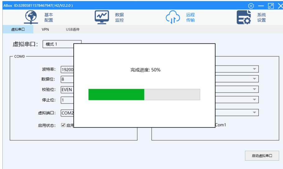
5、虚拟串口建立完成后，可打开编程软件，选择虚拟的 COM 口，进行连接，从而实现远程对 PLC 的在线下载程序、监控调试等功能。
