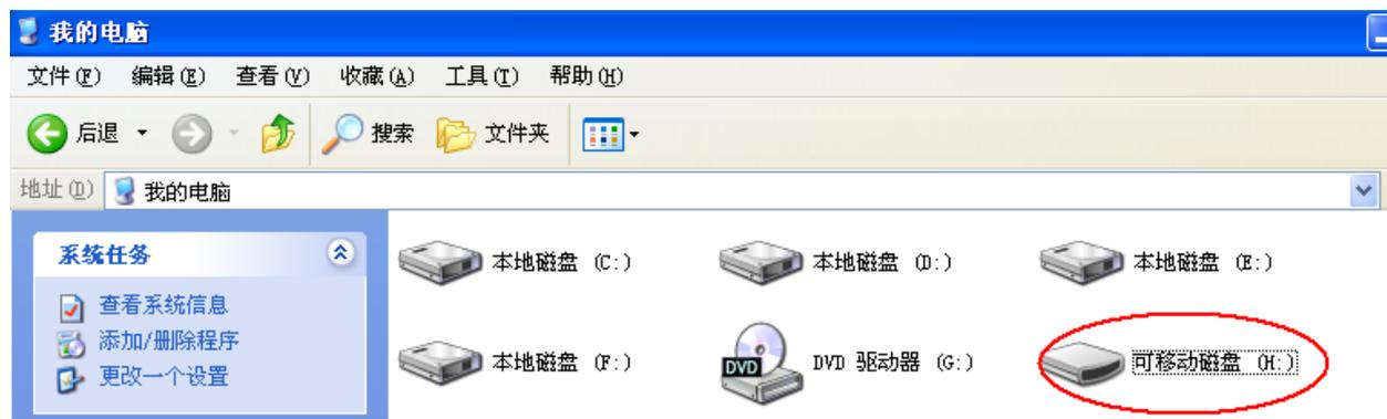
② 右键单击“可移动磁盘”（即 SD 卡），在弹出的菜单中选择“格式化”。
