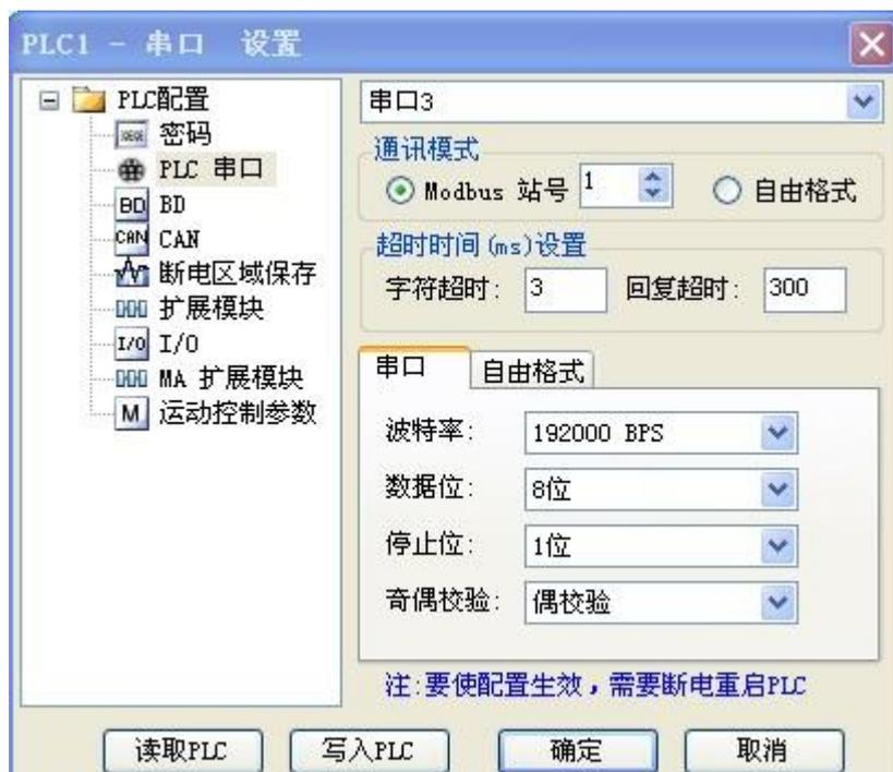
在选择好合适的参数后,点击写入 PLC,然后下载程序重新给 PLC 上电即可生效(注意 XC-OFC-BD 占用串口 3, 请勿修改 PLC 的串口 1 参数)。
