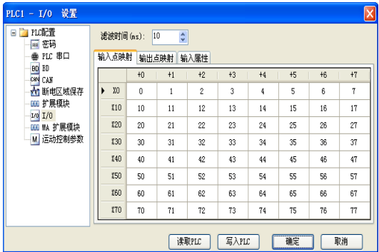
信捷PLC编辑软件I/O设置界面
