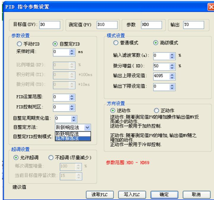
V3.5.1 及以上版本的软件中,可以对临界振荡法进行面板配置(阶跃响应法和临界振荡法可选配置)。
