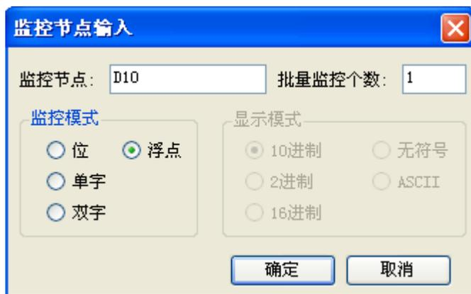
(2) 在“监控节点”框中输入 D10，“监控模式”选择浮点，点击“确认”键即可，您将会在自由监控栏中监控寄存器 D10 里面的浮点数数值。
