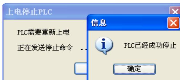
V) 直接点击“信息”窗口中的确认键, 再点击 PLC 编辑软件菜单栏上的“PLC 设置”按钮;
