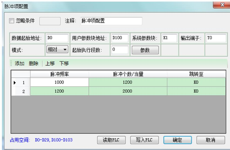
在该配置面板中可设定脉冲输出的形式，相对或者绝对；其他参数相应的输入区中写入参数的地址，以及脉冲频率、脉冲个数、跳转条件。
