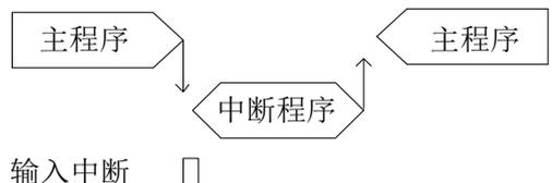
**注意：**在原来的 XC 系列 PLC 中外部中断不能够实现上升沿和下降沿共同触发；但是此问题在 XG 系列 PLC 中可以得到彻底的解决，外部中断同时支持上升沿和下降沿。
